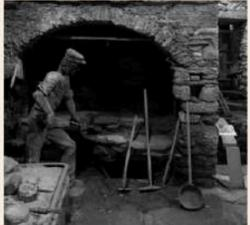
I fonditori lavoravano davanti al forno a una temperatura di oltre 1000° e si coprivano quindi con strati di juta bagnata di acqua e cenere, che al calore del forno si seccava formando quasi una corazza. Un tempo non c'erano termometri e solo l'esperienza permetteva di capire quando il rame era cotto al punto giusto per essere raccolto e messo nelle formelle.
